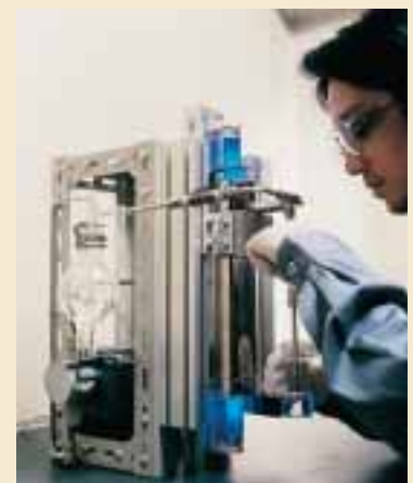
光触媒繊維を活用したダイオキシン分解実験
