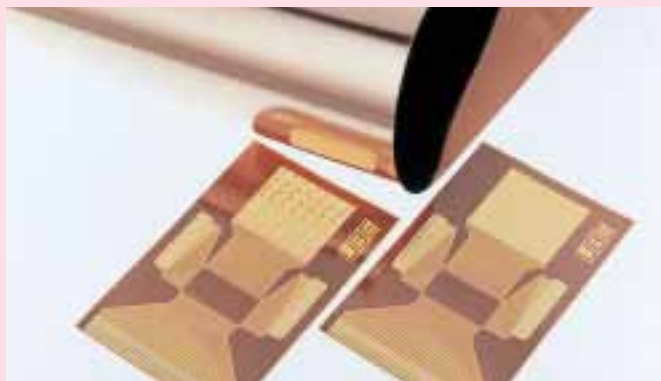
ポリイミドフィルムの用途例(2層CCL(無接着剤タイプ銅張積層板))
