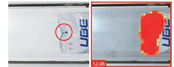
疑似異常品(袋の破れ) 異常部位をAI認識(破れ、皺)
