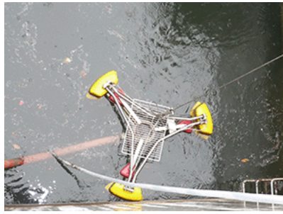
UBEエラストマーのポリエチレンペレット回収装置
