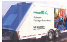
HF-150型水素配送充填装置。150kg貯蔵。35MPa
